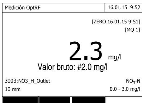
Además del parámetro medido, en el display se visualiza la cifra de evaluación de la calidad de la medición (MQ), y que es guardada junto con el parámetro medido.
